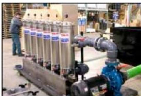
排油処理施設において、ハームスコフィルターシステムを導入し、新しい排水基準をクリアしました
